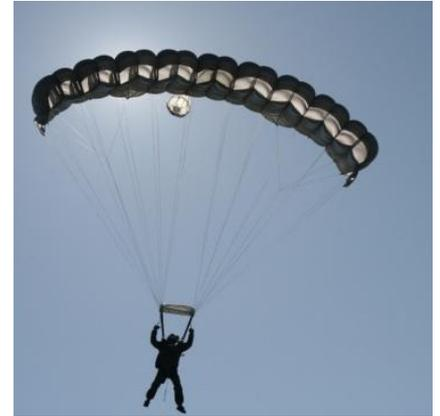
La campana táctica Plus de configuración By Pass está disponible en cuatro tallas diferentes, de 9 ó 11-Celdas, con tejido de baja porosidad (0.5-3CFM) o híbrida (0CFM en el techo y 0-3CFM en costillas y suelo). El P/N 317563-( ) puede ser utilizado indistintamente como campana principal o reserva.
