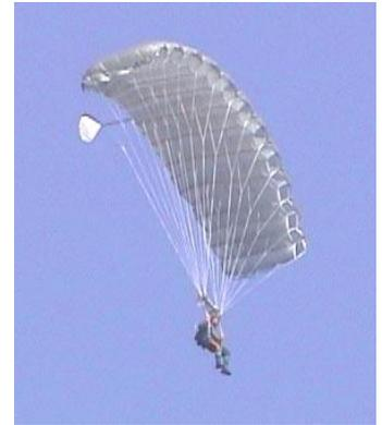
La campana **PLUS-350 03CFM 7-CELL**, para ser utilizada indistintamente como campana principal o reserva destaca principalmente por su seguridad, fácil manejo, consistencia de vuelo, precisión en aterrizajes y razonable capacidad de planeo. Dado su dócil comportamiento se convierten en una campana ideal para las primeras fases de entrenamiento de caída libre, saltos HALO, aterrizajes de precisión y amerizajes previos al rendez-vous.
